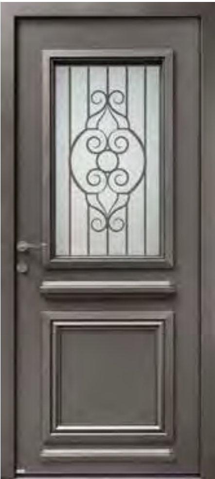
SOFFI 2 Vitrage feuilleté sablé classe 2 avec sérigraphie couleur gris RAL 9007 uniquement, moulures 2 faces identiques. Cimaïse face extérieure uniquement. Gris DB 703 texturé. Option : plinthe accordée (disponible uniquement sur les modèles SOFFI 1/2/3). Ud : 1.2
